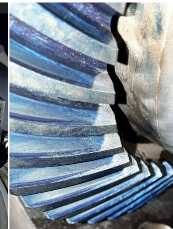
LINKS Pinion | MITTE Differenzial-Kegelräder im Gehäuse RECHTS Tragbildeinstellung mit Touchier-Farbe
